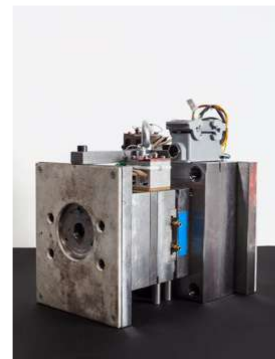
Das Team des Fraunhofer IPK entwickelte dieses Spritzgusswerkzeug zur Replikation der Musterbauteile.
