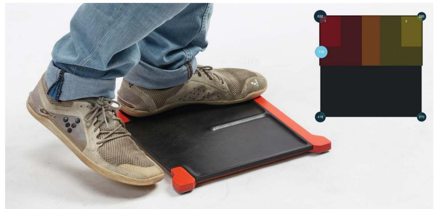
Bild 2: Eine GUI macht den Schwerpunkt sichtbar
