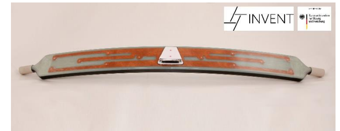
Beispielhafte Umsetzung eines integrierten Sensornetzwerkes am Beispiel einer Blattfeder. Quelle: INVENT
