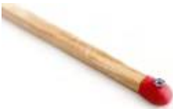
Figure 2.8 Miniaturized barometric pressure sensor, based on Piezoresistive principle (Source: CiS Forschungsinstitut für Mikrosensorik, Nadin Jurisch)
